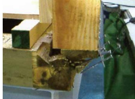
2回目の加振後に土台が大きく損傷
