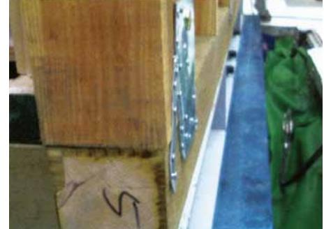
2回目の加振後も損傷なし
