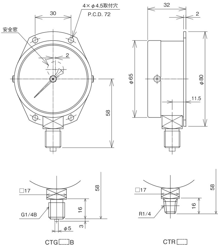
※壁面取付の場合、安全窓作動用の逃げ穴（φ25）を安全窓寸法位置に加工してください。
